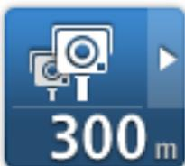
**Contrôle de la vitesse moyenne** : ce type de radar mesure votre vitesse moyenne entre deux points. Vous êtes averti à l'entrée et à la sortie de la zone de contrôle de la vitesse moyenne.
